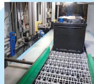
Комплекс со смарт-камерами для 100% автоматического контроля
